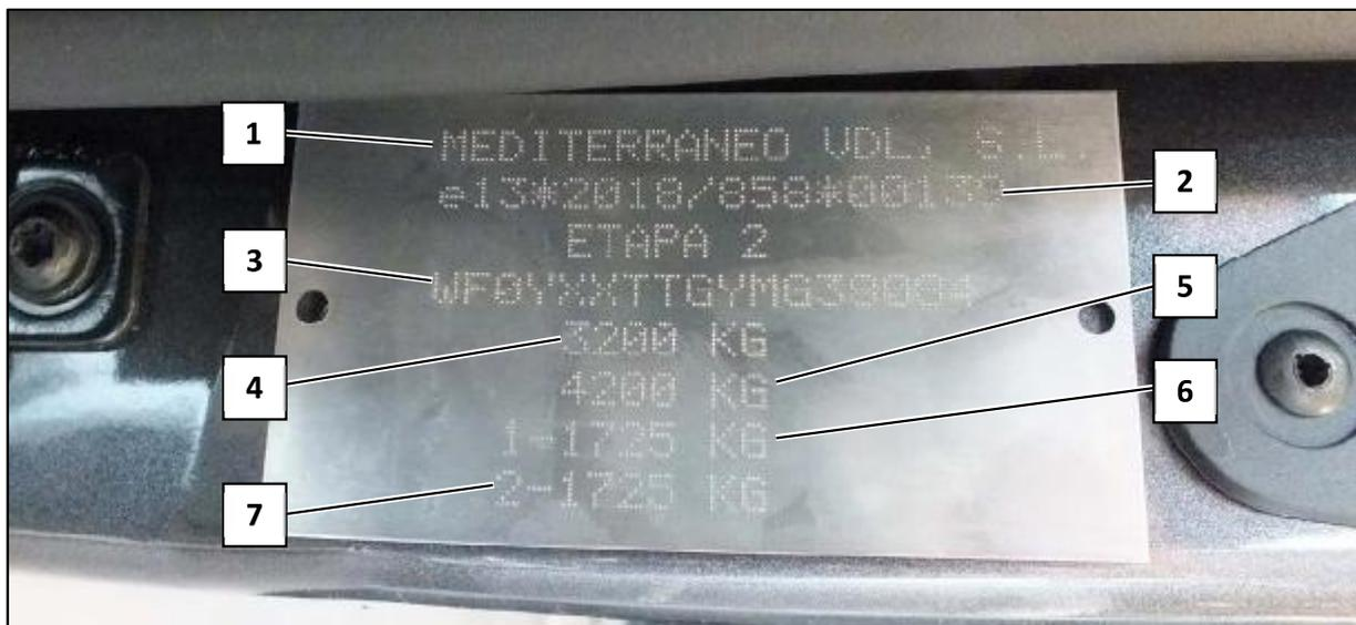
Typenschild im Einstieg der Seitentür (Abb. beispielhaft)
