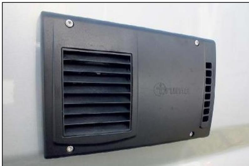
Abluft/Zuluft-Element an der Fahrzeugaußenseite (Abb. beispielhaft)
