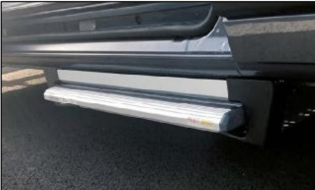
Optional ist das Fahrzeug mit einer elektrischen Trittstufe ausgestattet. Der Schalter zum Bedienen der Trittstufe befindet sich direkt neben der Schiebetür, im Einstieg, innen links.
