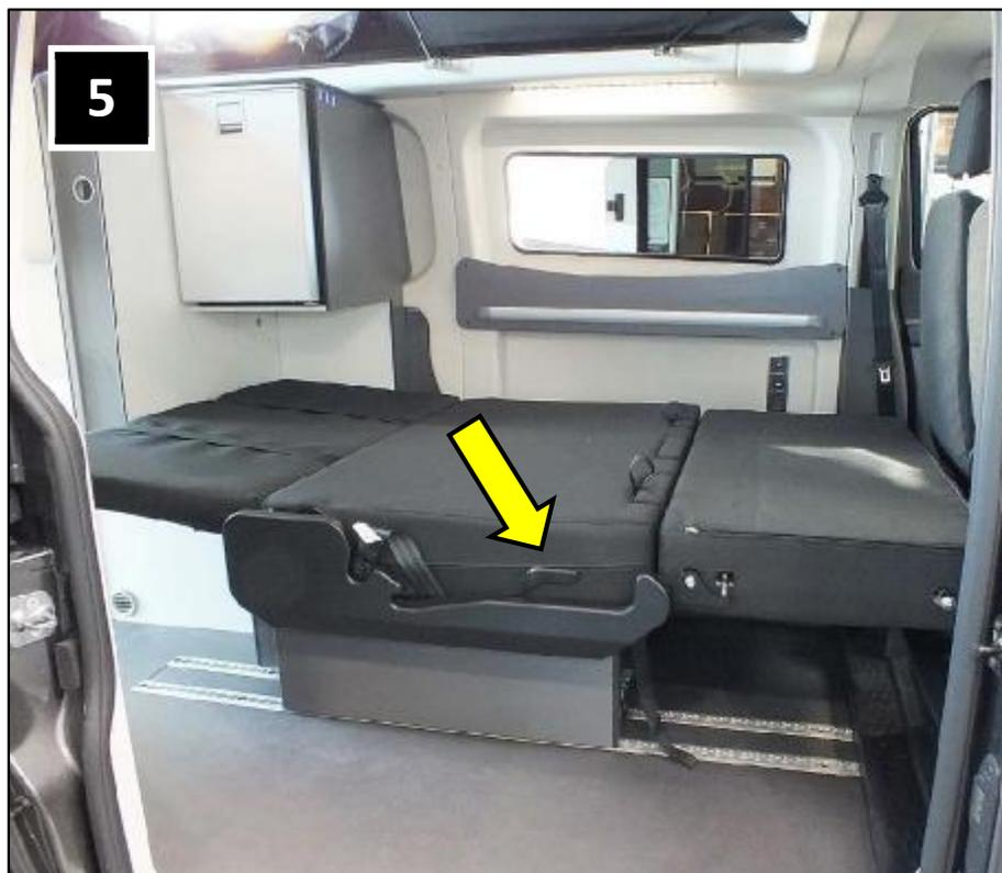
5. Klappen Sie die Rückenlehne um 90° nach vorne um. Hierzu muss der Entriegelungshebel (Pfeil) betätigt werden.
