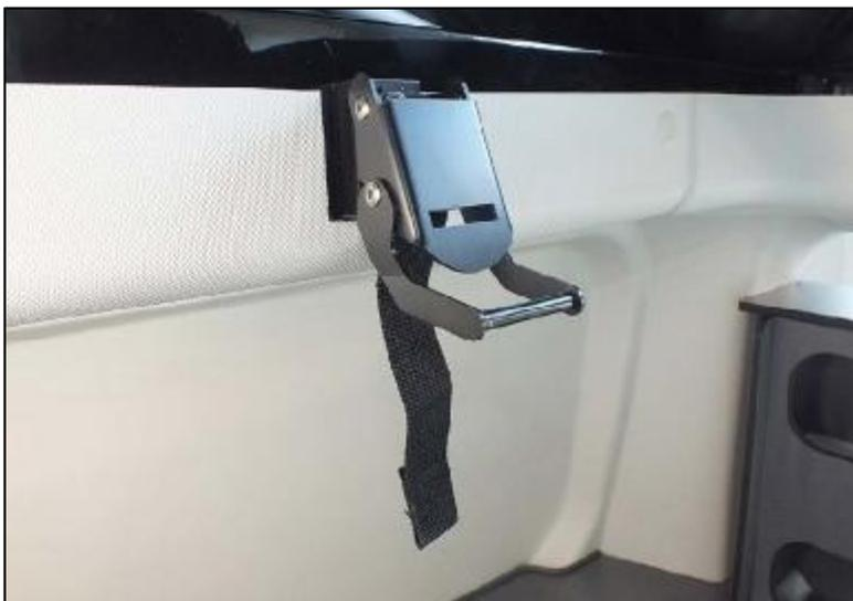
*Sicherungsverchluss zur Fixierung des Aufstelldachs (Abb. beispielhaft)*
